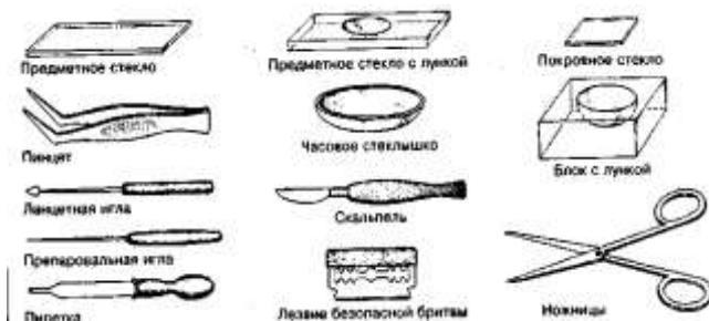
Рис. 2. Принадлежности для микроскопирования
